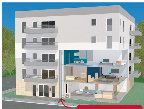
Arrivée de la fibre en souterrain
