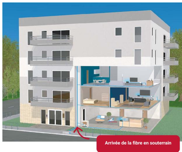
La fibre emprunte généralement le même chemin que le réseau télécom cuivre déjà en place quand il existe. S'il n'existe pas ou si ce passage n'est pas identifié, une solution est proposée par le technicien de raccordement.
