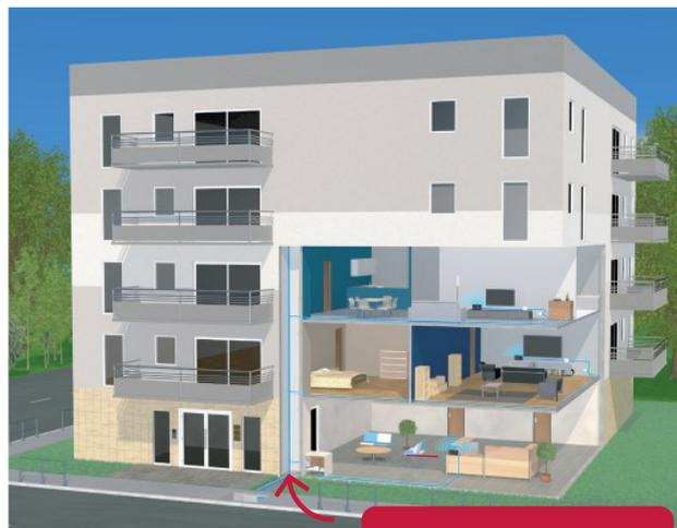
La fibre emprunte généralement le même chemin que le réseau télécom cuivre déjà en place quand il existe. S'il n'existe pas ou si ce passage n'est pas identifié, une solution est proposée par le technicien de raccordement.
