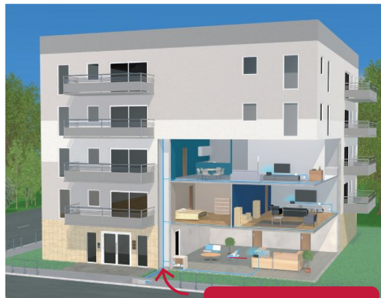
Arrivée de la fibre en souterrain
